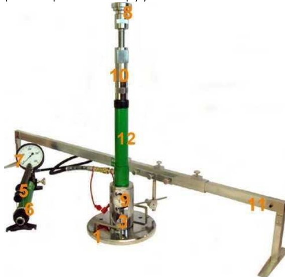
Rys. 1.2. Aparatura VSS z jednopunktowym pomiarem przemieszczenia płyty
