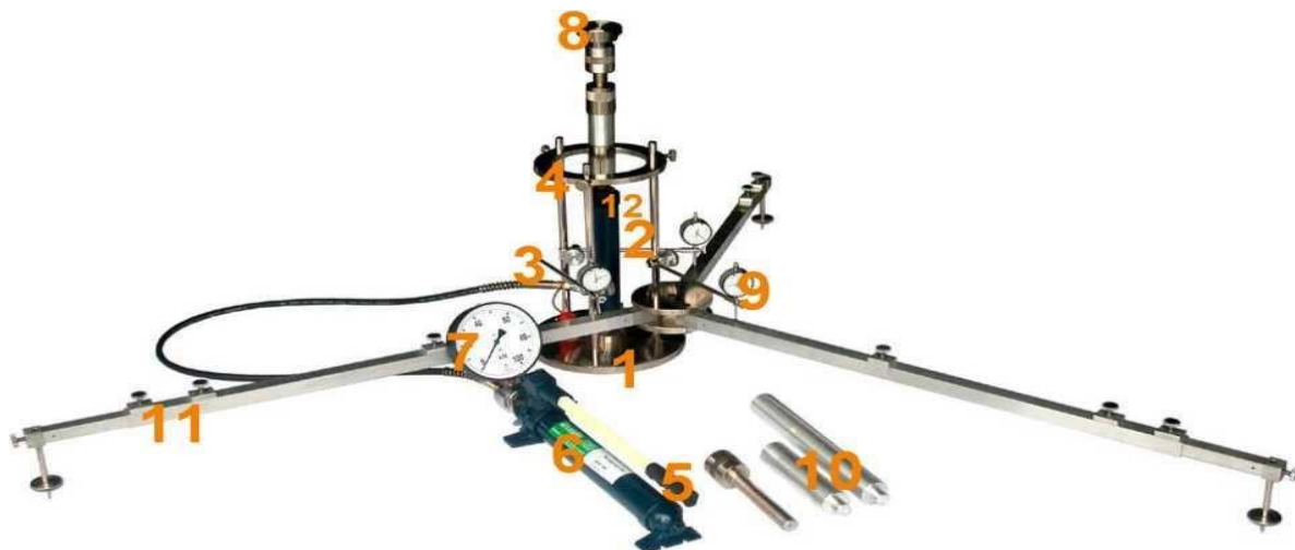
Rys. 1.1. Aparatura VSS z trzypunktowym pomiarem przemieszczenia płyty
